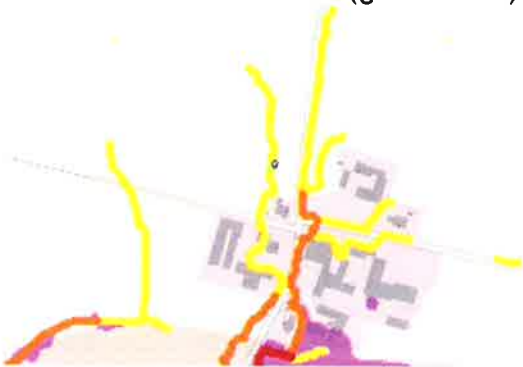
Abb.: potentielle Fließwege bei Starkregen (gelb- mäßiger Abfluss, orange- erhöhter Abfluss, rot- starker Abfluss)
